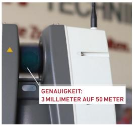
Diese Technik punktet mit einer Genauigkeit von 3 Millimetern auf 50 Meter Abstand.
