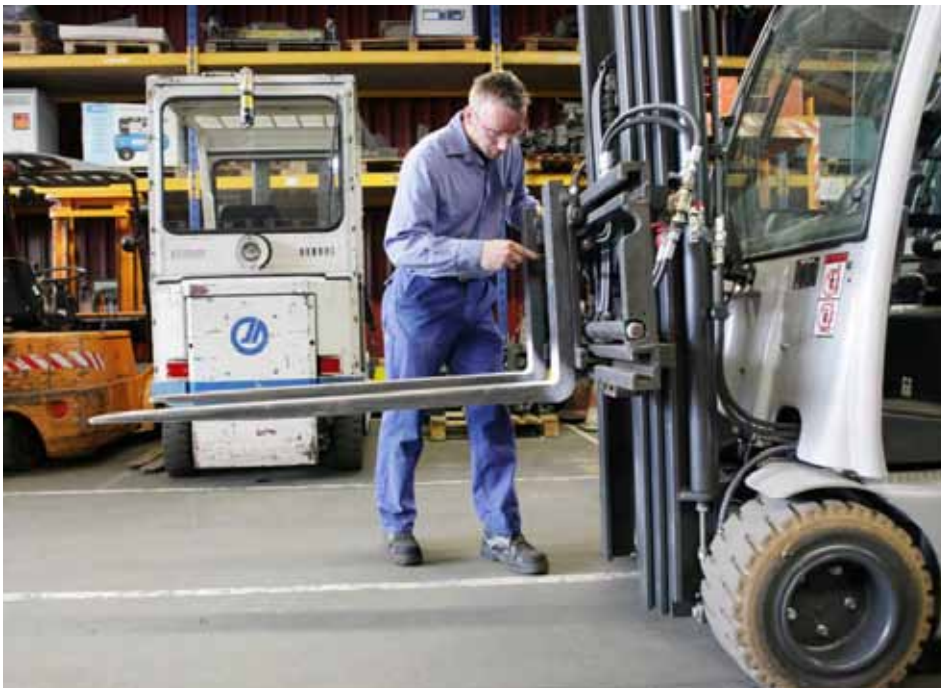
Routinemäßige Gabelprüfung an einem Gabelstapler gemäß UVV
