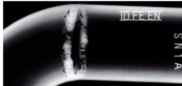
Rundnaht DN50, verschweißt mit falschem Schweißzusatzwerkstoff.
