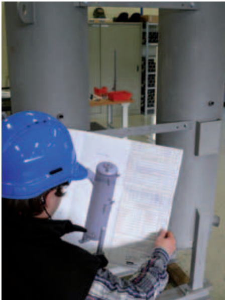
Endabnahme eines Druckbehälters
